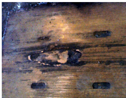
Fig. 1. Ponto de desgaste aço Hardox-450.
